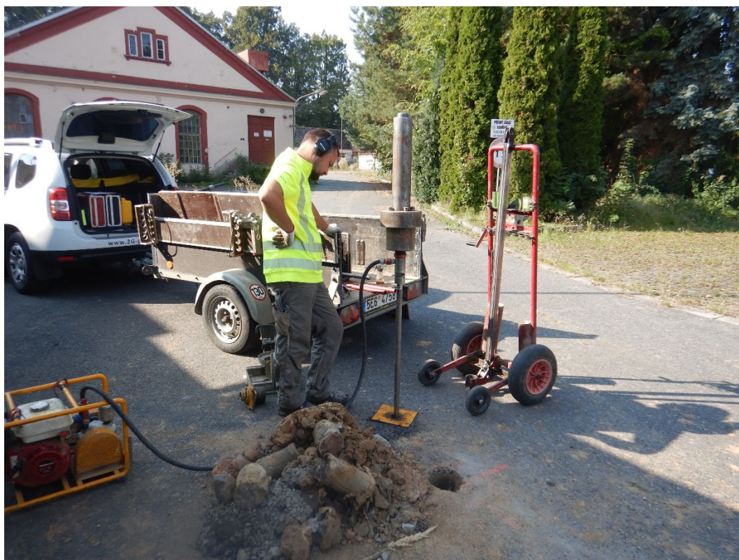
Obr. 14: Nahrazení havarovaného vrtu J4 sondou těžké dynamické penetrace DPH1 o hloubce 10 m (12. 9. 2023).
