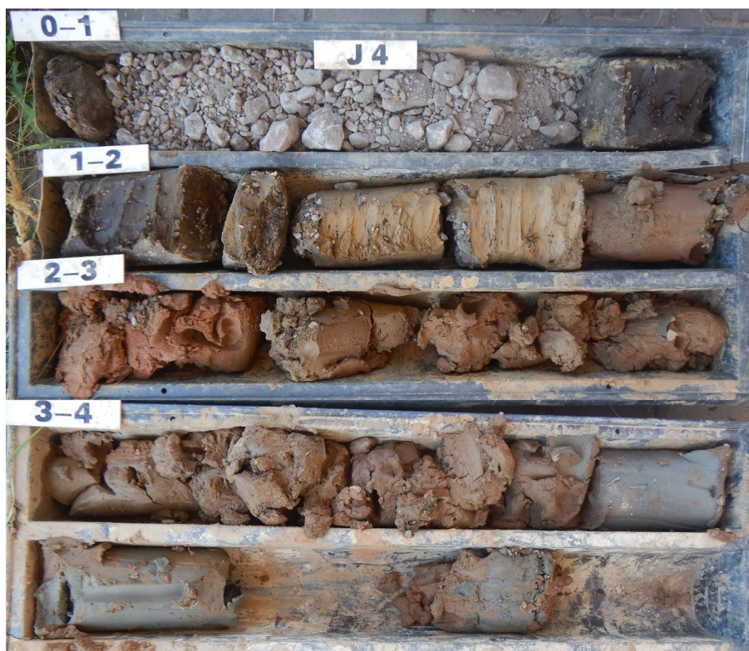
Obr. 13: Jádrový vrt J4 o hloubce 4,5 m – havárie vrtu (7. 9. 2023).
