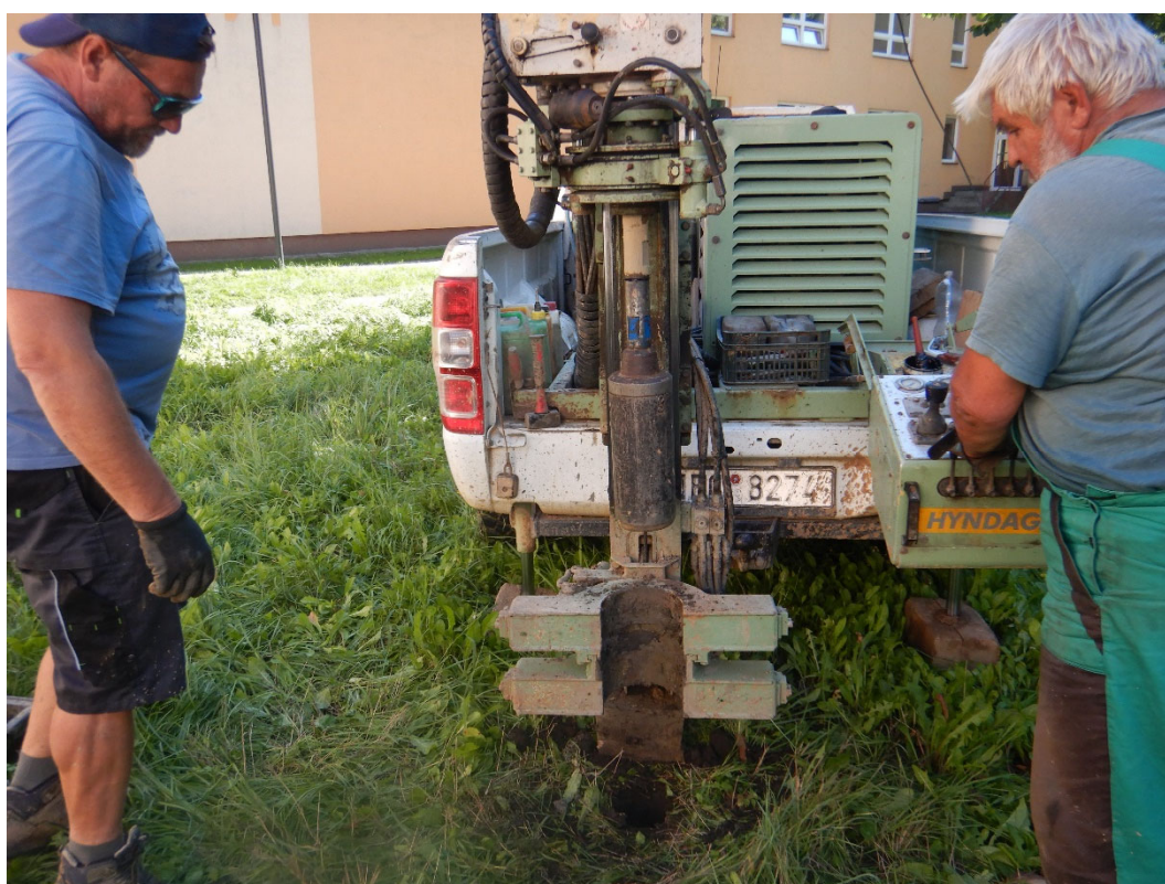
Obr. 8: Odběr neporušeného vzorku č. 33549 z jádrového vrtu J2 (6. 9. 2023).
