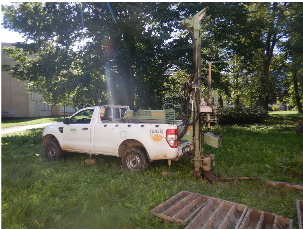
Obr. 7: Realizace jádrového vrtu J2 (6. 9. 2023).
